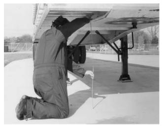
Figure 12. Measuring the actual kingpin height
